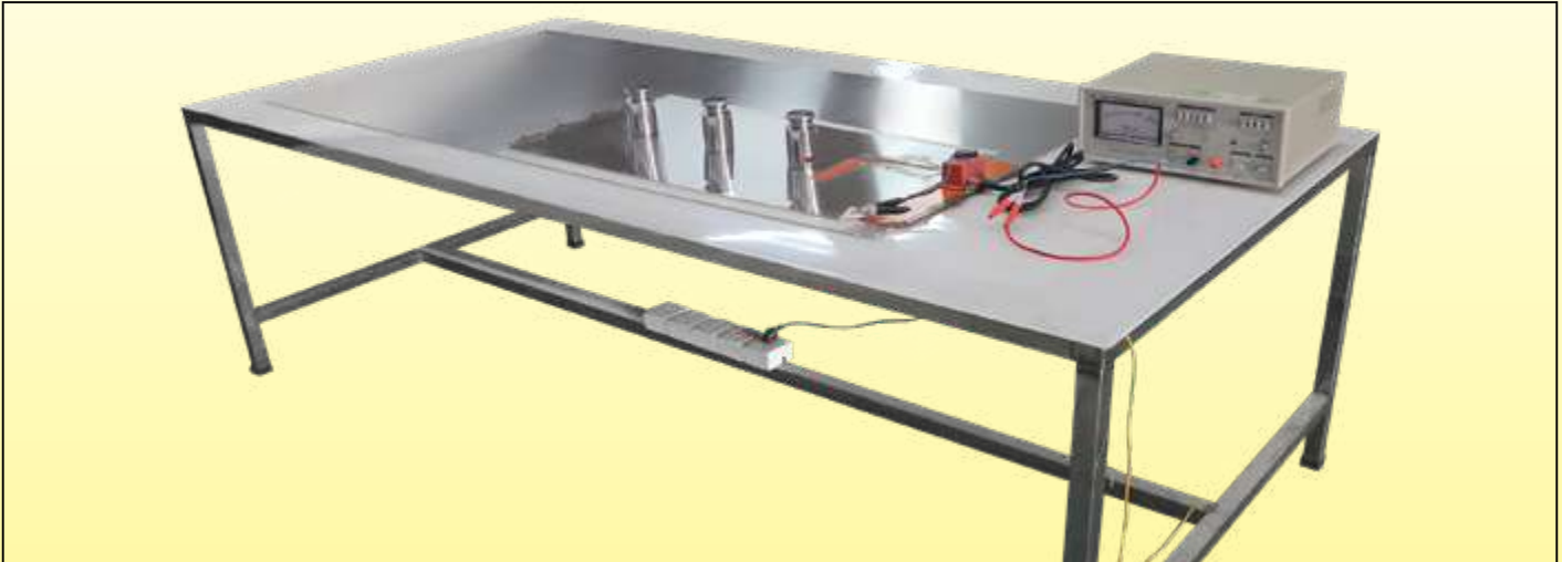
Dispositif de mesure de la résistance d'isolement. Les valeurs mesurées sont toujours supérieures à 0.1Gohm
