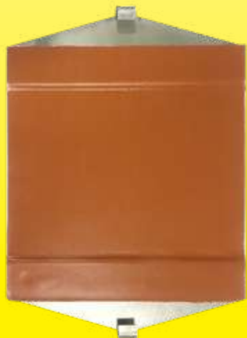
Echantillon destiné à la mesure de la force d'arrachement
