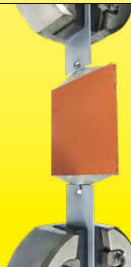
Equipement de mesure de la force d'arrachement
