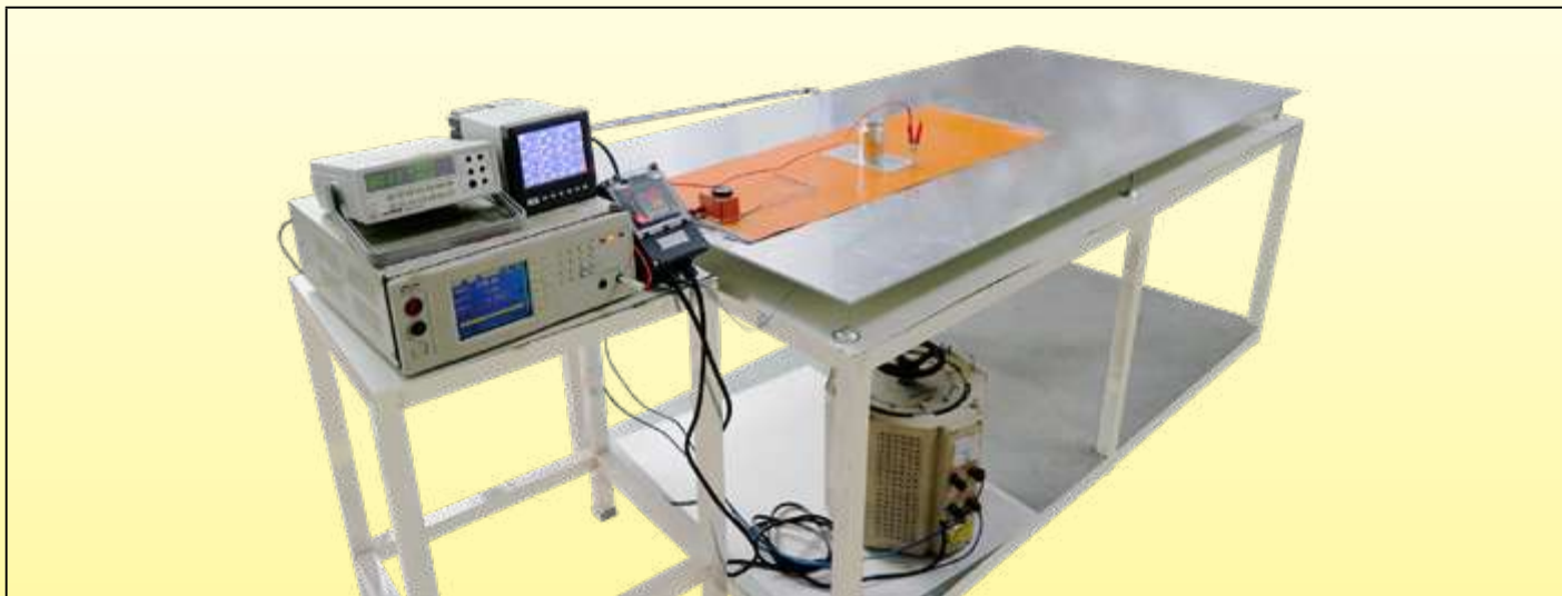
Dispositif d'essai de mesure du courant de fuite à chaud
